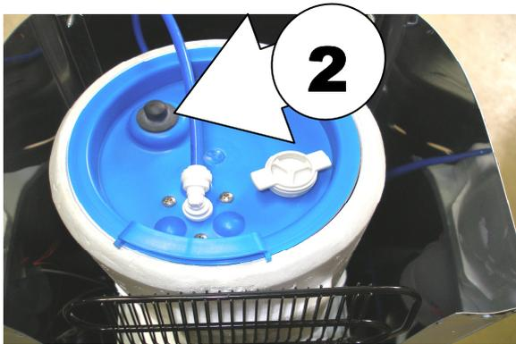
Le réservoir est équipé d'un flotteur de remplissage et d'un flotteur de sécurité. Si le niveau d'eau dépasse le flotteur de remplissage, le flotteur de sécurité coupe l'alimentation d'eau. Il est alors nécessaire remettre le flotteur de sécurité en position « normal », pour cela :
