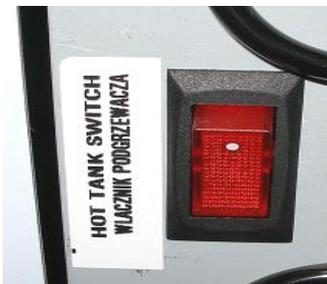
Avant de sortir de l'eau chaude, ouvrir l'eau pour remplir le réservoir d'eau chaude puis appuyer sur le commutateur à l'arrière de l'appareil (appuyer coté point blanc).
