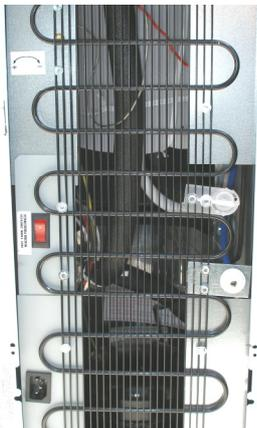
La seule maintenance au niveau du compresseur est le nettoyage du condenseur (grille au dos).
